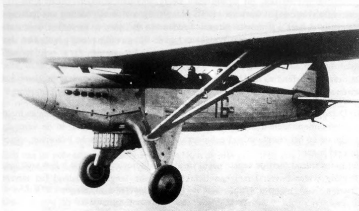
'R.16'. De Renard, type R-31 naar het jaar waarin hij ter studie werd genomen is een metalen tweepersoons ééndekker met open cockpit. Op 4000 m behaalt hij een snelheid van 290 km/u. (Verz. CHD/Evere)
